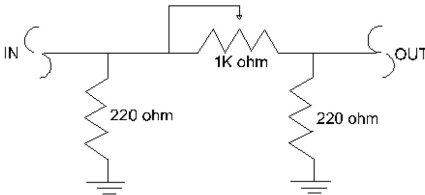
Figure 2-Attenuator (variable)
